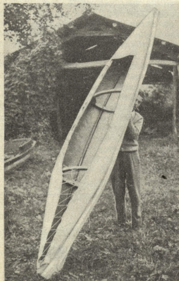
L'imbarcazione, con la copertura in tela già sistemata sullo scheletro: l'allacciatura della parte poppiera non è stata stretta, del tutto, per illustrare come i laccioli vanno fatti passare attraverso i fori sui lembi del tessuto.
